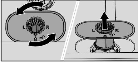
1. Drehen Sie den Arretierring gegen den Uhrzeigersinn und heben Sie den Filter gerade nach oben heraus.
