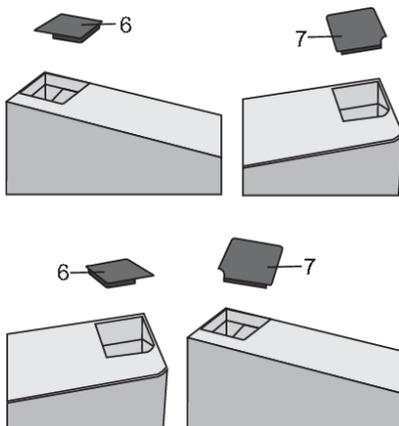
Entfernen Sie den Deckel (6) von der linken Seite der Tür. Entfernen Sie dann den Deckel (7) von der rechten Seite der Tür. Setzen Sie den Deckel (7) auf der linken Seite der Tür und den Deckel (6) auf der rechten Seite der Tür auf.
