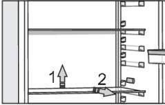
Sie können leere Ablagen nach Belieben über die Führungen im Kühlschrankinneren verlegen, ohne diese aus dem Kühlschrank nehmen zu müssen. Um die Ablage zu bewegen oder aus dem Kühlschrank zu nehmen, heben Sie sie hinten leicht an, ziehen Sie sie in Ihre Richtung und verlegen Sie sie oder nehmen Sie sie aus dem Gerät heraus. Lagern Sie schnell verderbliche Lebensmittel an der Rückseite des Innenraums, wo die Temperatur am niedrigsten ist.
