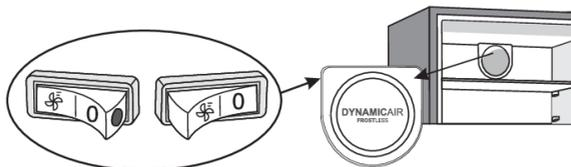
Wenn der Lüfter eingeschaltet ist, ist auf dem Schalter ein roter Punkt sichtbar.
