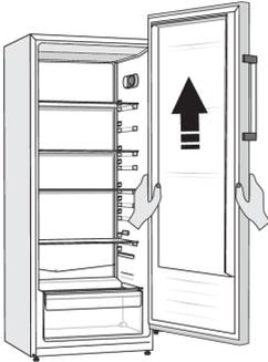
Entfernen Sie die Tür vom unteren Scharnier, indem Sie die Tür vorsichtig gerade nach oben heben. Legen Sie die Tür auf eine glatte Oberfläche.
