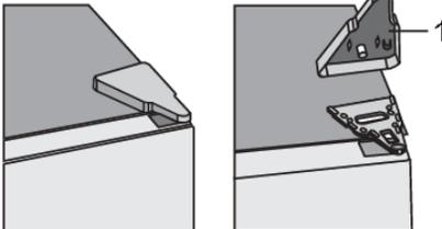
Entfernen Sie die obere Scharnierabdeckung (1).
