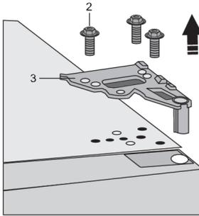
Lösen Sie die Schrauben (2) und entfernen Sie das Scharnier (3). Halten Sie die Tür dabei fest, damit sie nicht herunterfällt.
