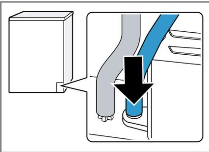
4. Den Wasserablaufschauch in die Schlauchführung einsetzen.
