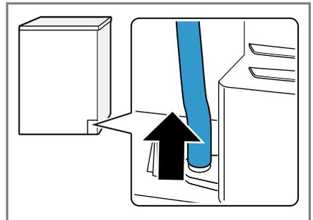
Der Kondenswasserschlauch ist werkseitig am Stutzen angeschlossen.
