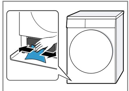
9. Den Einsatz waagerecht bis zum Einrasten der Lasche einschieben.
