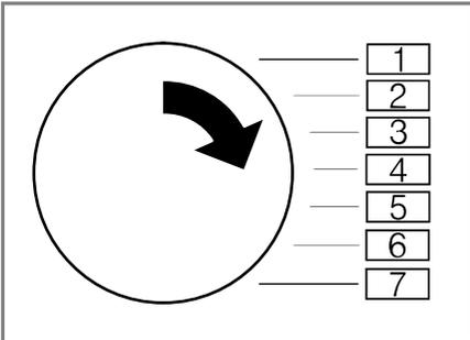
2. Auf **bügel trocken** drücken und gleichzeitig den Programmwähler auf Position 2 einstellen.
