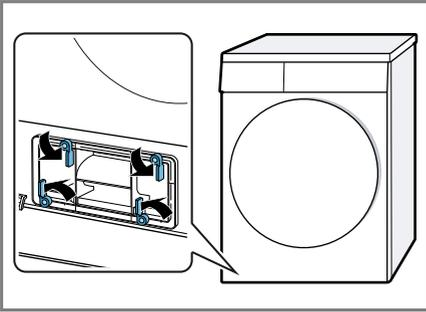
3. Die Wärmetauscherabdeckung am Griff herausziehen.
