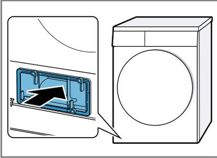
2. Die Hebel der Wärmetauscherabdeckung schließen.
