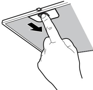
2. Metallfettfilter aus der Halterung herausnehmen.
